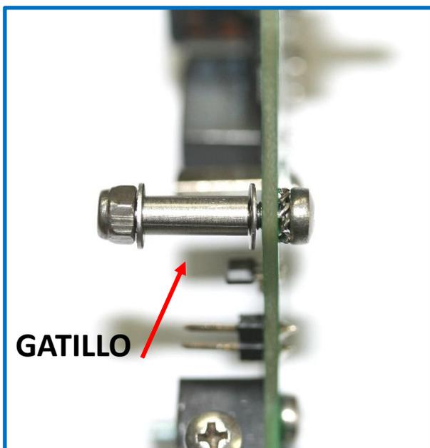
Esta es la forma correcta de ensamblar las piezas en el montaje del gatillo.
